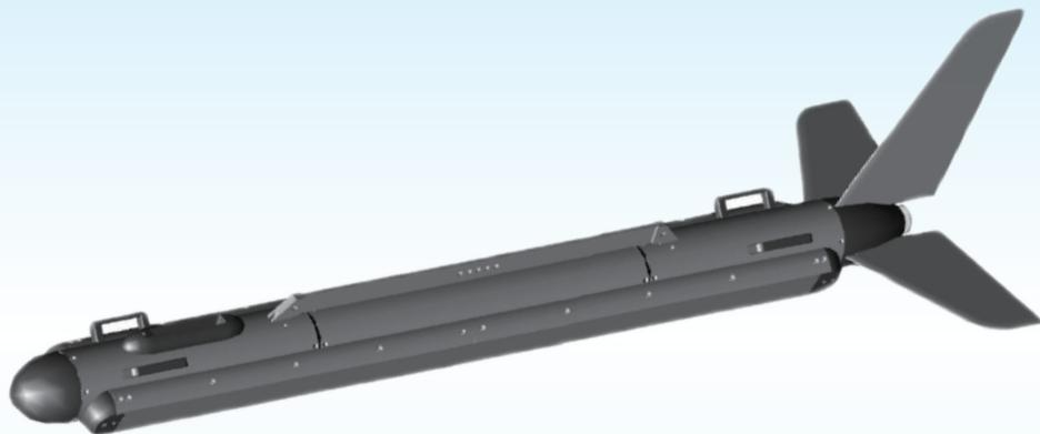
Shark-S609M多波束侧扫声呐具有低速和高速两种使用模式，可根据需要实时在线选择。低速模式为单波束双频侧扫，高速模式为高频多波束侧扫（双侧18个波束）。与常规侧扫不同，系统采用先进的动态波束聚焦技术，极大提高中、近距离沿航迹方向的分辨率，高速扫测则提高了测绘效率，两种技术实现高速高分辨率完美结合。
